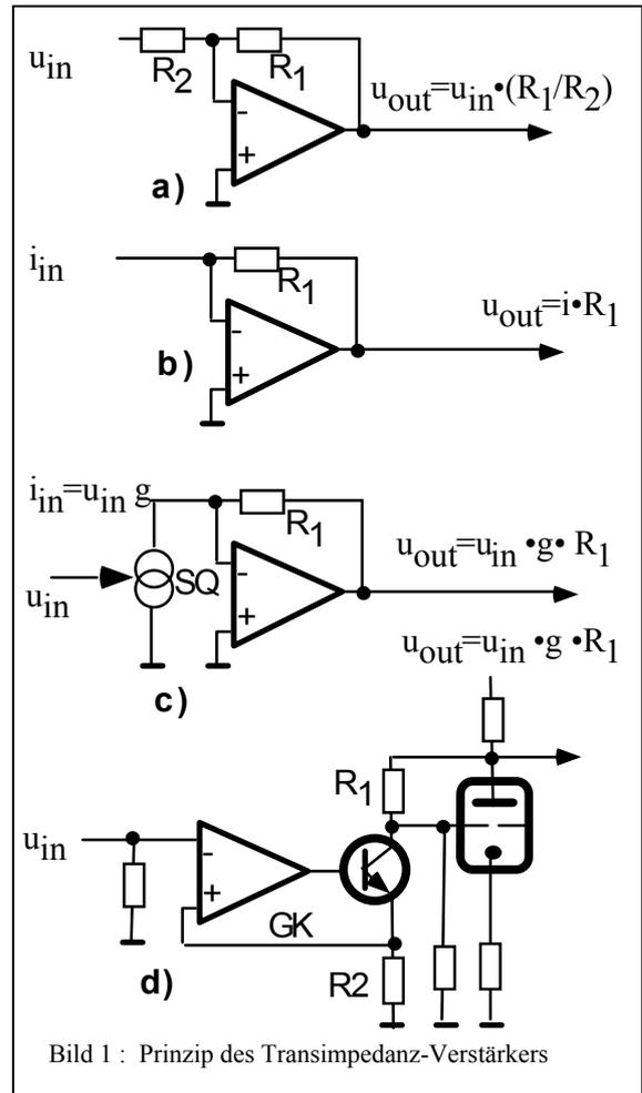
Bild 1 : Prinzip des Transimpedanz-Verstärkers
