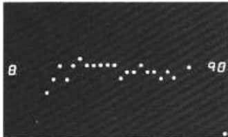
Courbe en bruit rose sur analyseur 1/2 octave 3 dB par rangée, niveau 90 dB, 31, 44, 63, 88, 125, 176, 250, 353, 500, 700, 1 k, 1,4 k, 2 k, 2,8 k, 4 k, 5,6 k, 8 k, 11,3 k, 16 k, 22,6 k.
